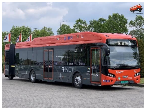
Figuur 23: waterstofbus van VDL met waterstof range extender
