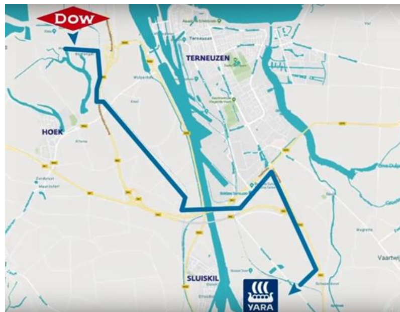
Figuur 11: De geconverteerde waterstofleiding tussen DOW en Yara
