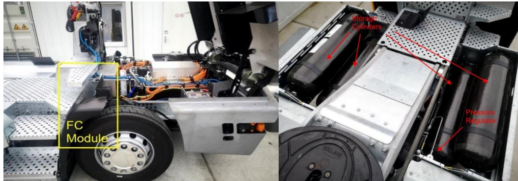
Figuur 17: fuel cell en H2 opslag tanks geïntegreerd in de Terberg terminal tractor YT 223-H2 door Zepp Solutions
