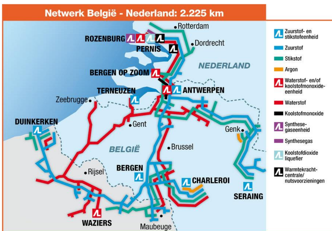
Figuur 9: Het Air Liquide netwerk van industriële gassen in België en Nederland
