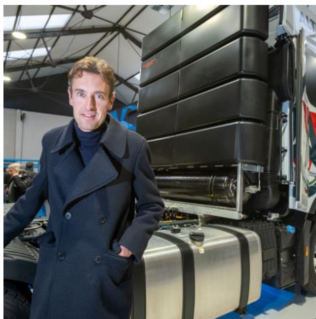
Vrachtwagen van CMB.TECH met dual fuel motor die op een combinatie van diesel en waterstof rijdt
